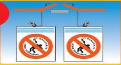
Bloquear en posición de apertura los aparatos de corte
